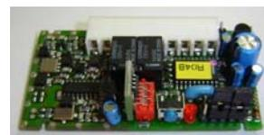
Appuyer sur le bouton de programmation du récepteur jusqu'à ce que la LED s'allume. Relâcher le bouton.
