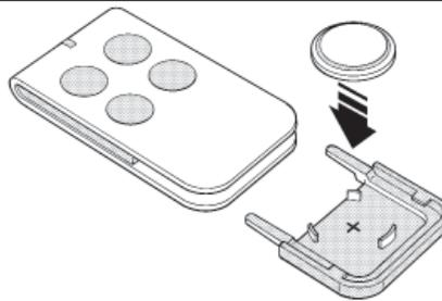
04. En tenant l'émetteur avec les touches vers le haut, remettre le couvercle en place en faisant en sorte que la « lamelle » représentée en gris se trouve au-dessus la pile, comme l'illustre la figure ci-après.
