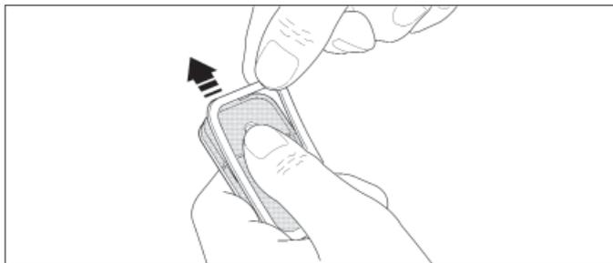
03. Enlever la pile usagée et la remplacer par une neuve, en faisant attention à la mettre en place en respectant la polarité indiquée (le signe + vers le bas).
