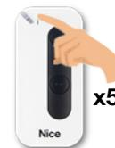
Appuyer et rester maintenu sur une des touches de l'émetteur jusqu'à ce que la LED s'allume en rouge, puis relâcher
